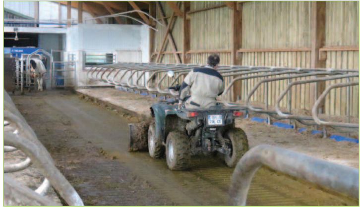
Photo 26 : Raclage des caillebotis avec un quad.
