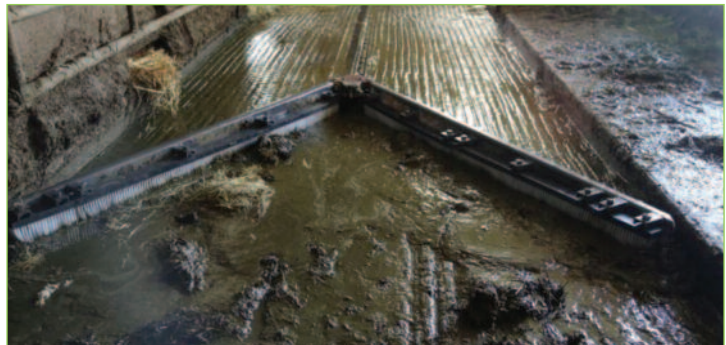
Photo 17 : Brosse fixée sur les volets d'un racleur en V pour améliorer l'efficacité du raclage.
