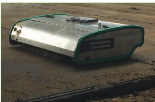
Photo 21 : Robot racleur et aspirateur de lisier pour les aires de tapis.
