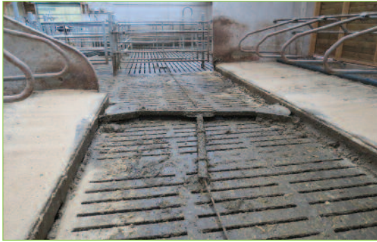
Photo 24 : Racleur droit à corde avec pièce d'usure sur caillebotis.
