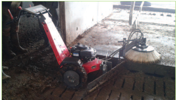
Photo 27 : Raclage des caillebotis avec un porte outil.
