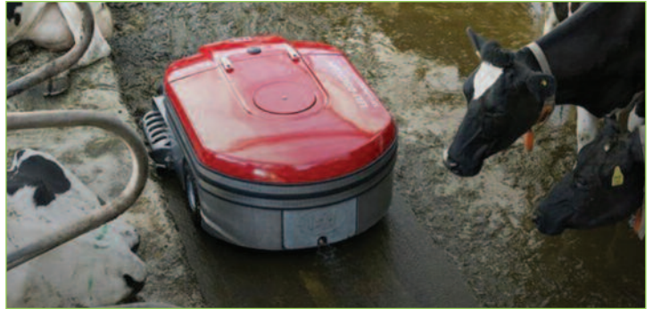
Photo 22 : Robot racleur et aspirateur de lisier pour les sols pleins.
